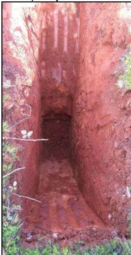
Fotografía N° 5 Punto de suelo – calicata Superficial, 200 y 300 cm
