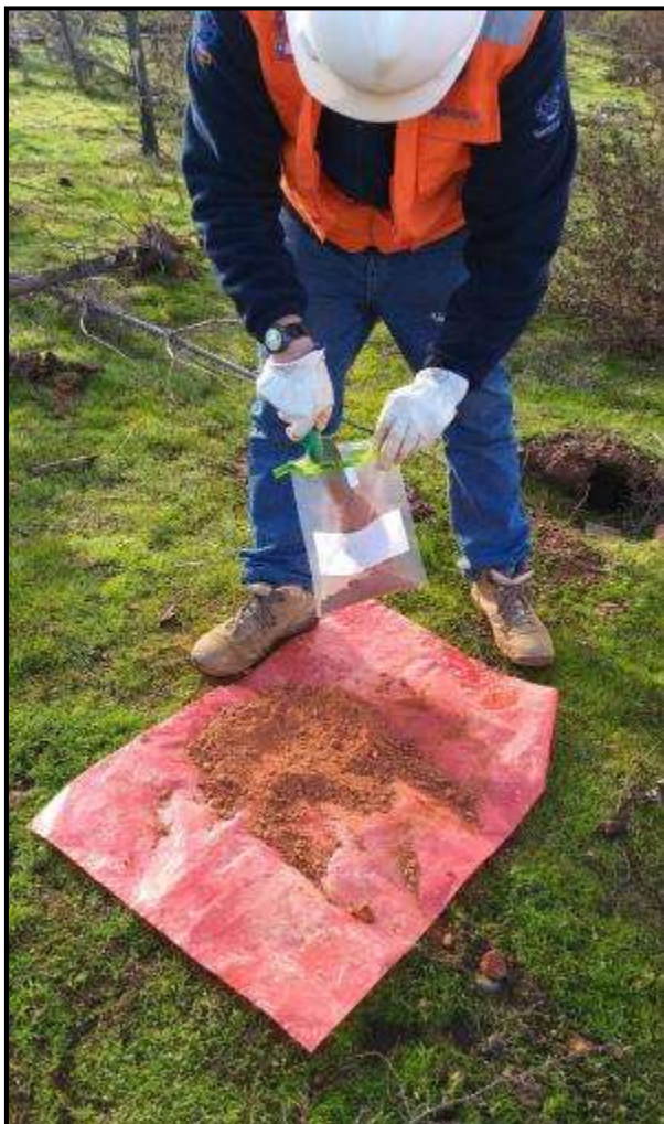
Fotografía N° 5 Punto de suelo – calicata Superficial, 200 y 300 cm
